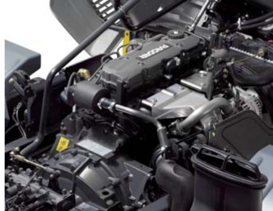
Čtyřválcový motor PACCAR FR o zdvihovém objemu je k dispozici s výkony od 140 k do 180 k.
