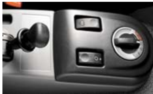
Ovládací panel automatické převodovky AS-Tronic se nachází na konzole vedle sedadla řidiče.
